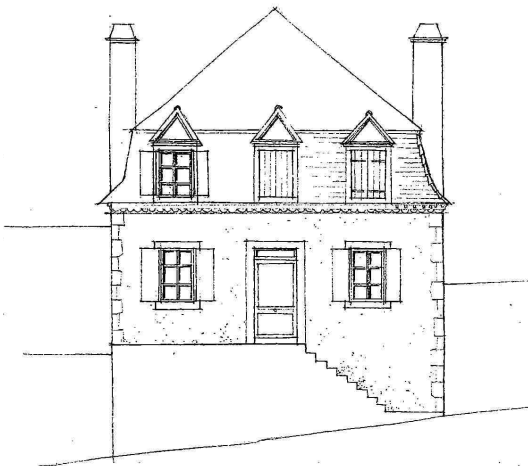
composition à trois travées et symétriques autour de la porte
